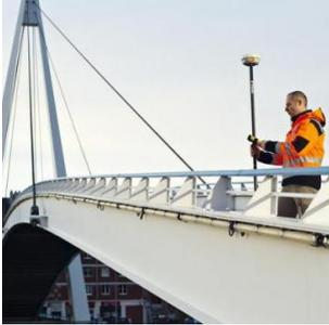
**Monitoraggio di infrastrutture e versanti:** il GNSS per mezzo delle stazioni permanenti trova grande applicazione nei monitoraggi di deformazioni geologiche sia riferito a movimenti di fenomeni naturali, ad esempio movimenti franosi, sia per il controllo di grandi opere quali ad esempio dighe e ponti.
