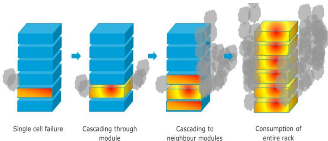
Figura 4 Assenza barriere termiche: Cascading Thermal Runaway
